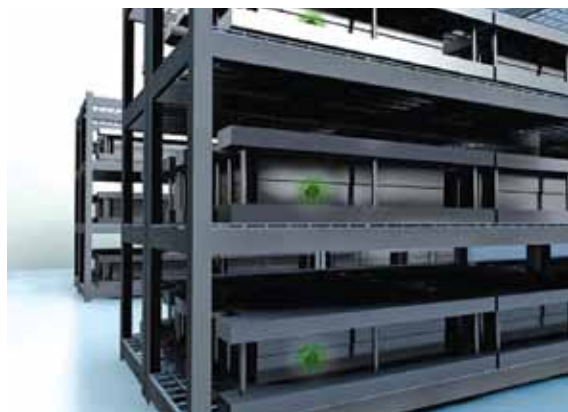
Al adherir etiquetas RFID en moldes y matrices, se pueden rastrear y descargar parámetros de configuración, uso y adaptación de componentes
