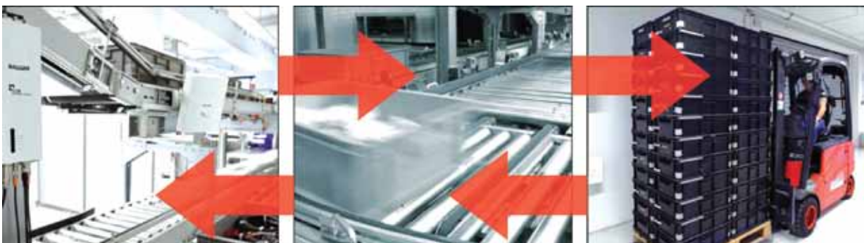
Las etiquetas UHF RFID registran todos los movimientos de fabricación, desde la entrada de componentes hasta la salida del producto final
