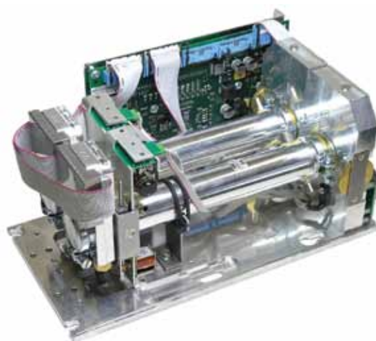
Módulo de análisis Uras26: consiste en un fotómetro NDIR que aplica la ley de Lambert-Beer para la medición de concentraciones de gases activos en el espectro infrarrojo. La medición de hasta cuatro componentes es posible debido al diseño de doble celda en paralelo, utilizando detectores de gas selectivos independientes para cada componente a medir
