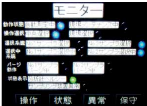
Figura 8. Pantalla táctil del sistema de medición de la salida de gases (versión japonesa únicamente)
