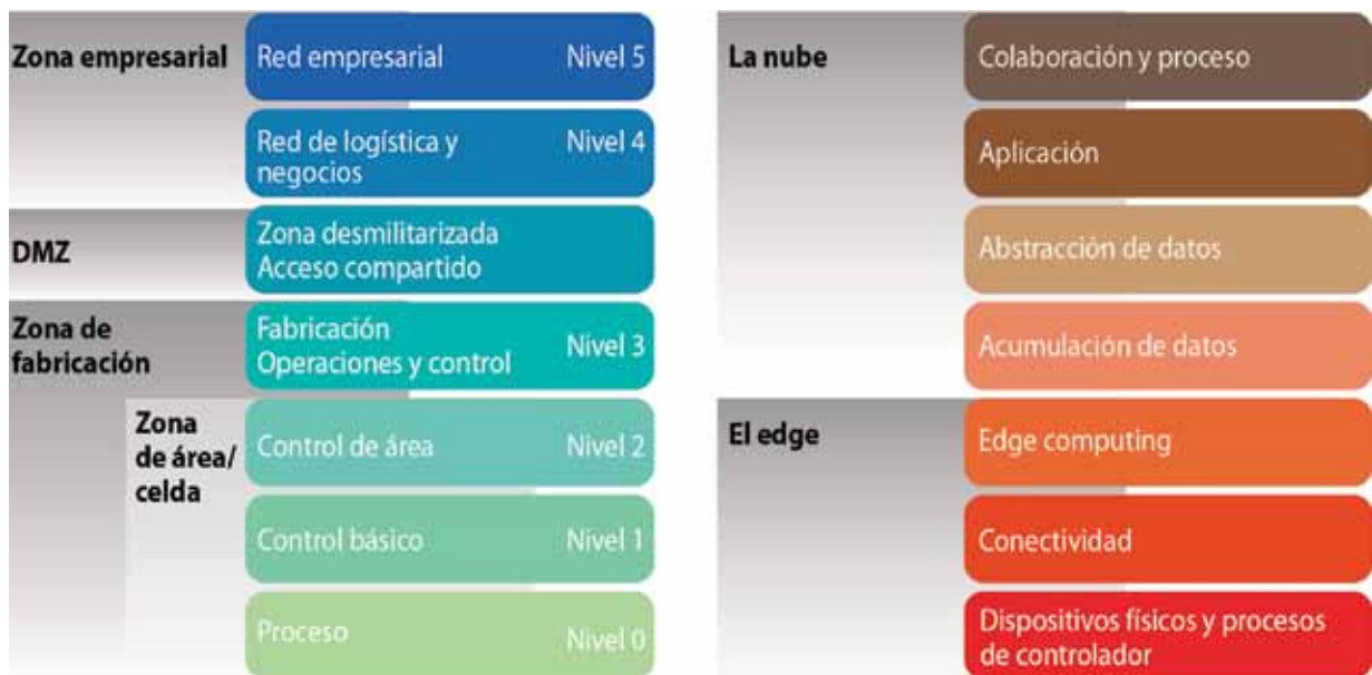
Figura 2. El típico modelo de Arquitectura de Referencia Empresarial Purdue (PERA) comparado con un modelo de referencia de Internet de las cosas de Cisco, a la izquierda y derecha, respectivamente
