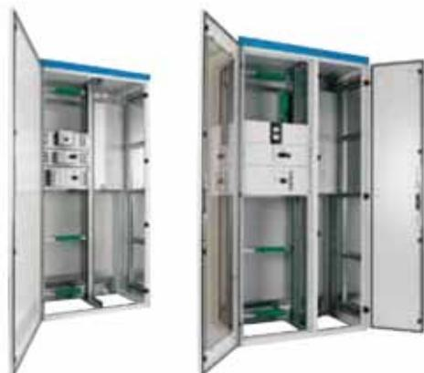
Altura de dos mil milímetros (2.000 mm), anchos de ochocientos, mil y mil doscientos milímetros (800, 1.000 y 1.200 mm) y profundidades de seiscientos y ochocientos milímetros (600 y 800 mm). Compartimentación interna hasta 4b; zona de salida de cable con ancho de cuatrocientos veinticinco y seiscientos milímetros (425 y 600 mm). Grado de estanqueidad IP 31 (con rejillas) o IP 55 (versión estanca).
