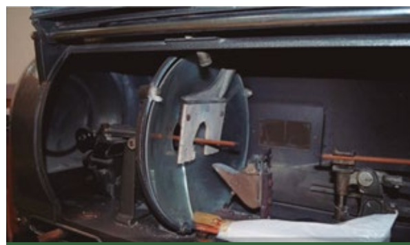
Lámpara de arco de proyección unidireccional. Se utilizó hasta la década de los '70 para proyección de cine y seguidor en el teatro. Se observan ambos electrodos de grafito cobreado en periferia y el espejo parabólico. El punto de ignición debe permanecer en el foco de la parábola.
