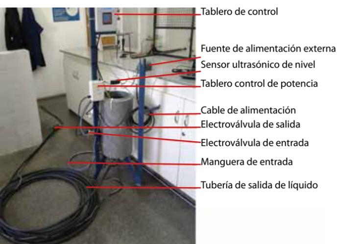
Figura 6. Planta piloto y las instalaciones
