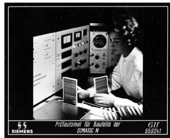
Instalación para constatar Simatic N
