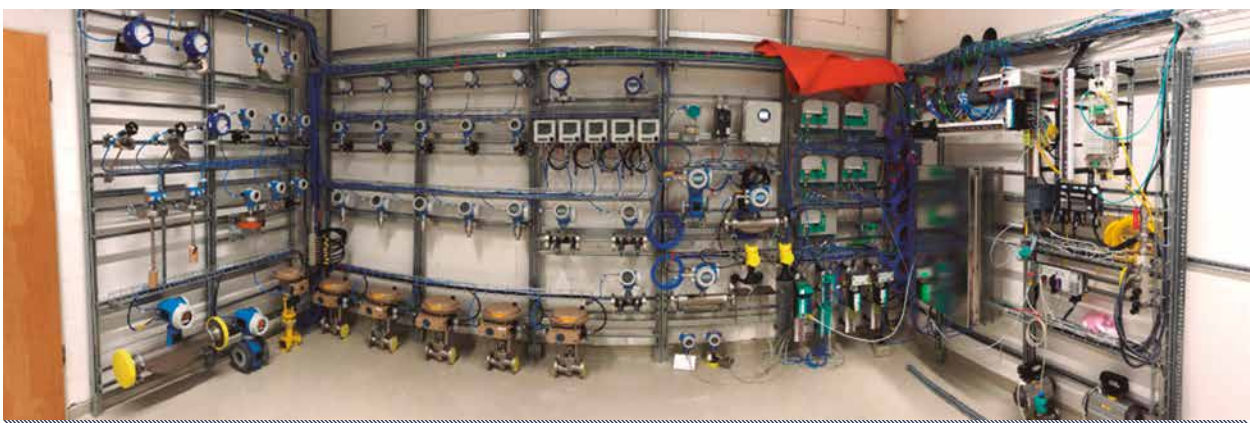
Figura 14. Prueba de interoperabilidad de Ethernet APL
