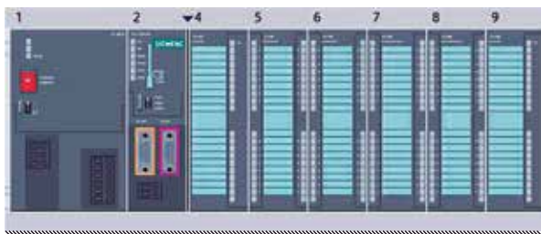
Figura 2. PLC y módulos de expansión
