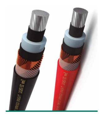
La línea Termolite, de Cimet, de cables de potencia para tensiones nominales de 3,3 (3,6) hasta 33 kV (36 kV) eficaces, se destaca por la aislación con polietileno reticulado (XLPE). Tanto uni- como multipolares se pueden colocar en un amplio rango de aplicaciones, que van desde instalaciones fijas en el interior de edificios civiles e industriales (sobre bandejas, en canaletas, conductos, etc.), hasta la intemperie o en forma subterránea.
