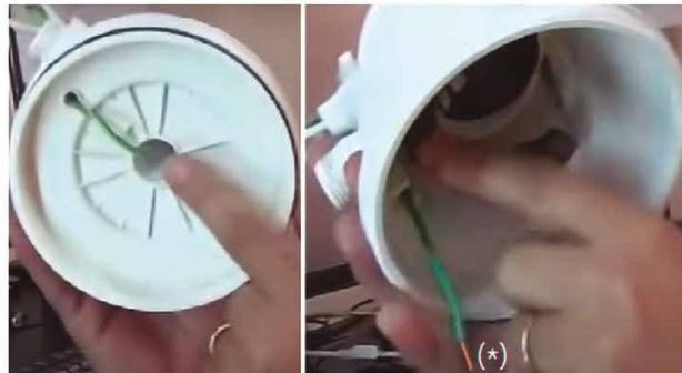
En una ducha con resistencia expuesta, el agua pasa frente a un tramo pelado del PE (\*) antes de salir para retornar a tierra por él la mayor parte de la fuga.
