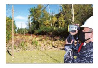
Easy Target es una herramienta óptima para determinar la altura de los tendidos eléctricos a largas distancias, así como de árboles, antenas, edificaciones, o cualquier otra estructura presente en el terreno.
