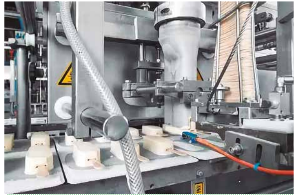
Posicionamiento perfecto: el núcleo de los helados Magnum sale de la extrusora a gran velocidad. Durante el proceso de extrusión, se inserta el palillo.
