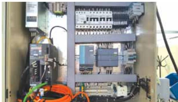
En este caso, se requirió una mejora en la planta de la provincia de San Luis sobre una prensa balancín que produce las lamelas de los radiadores de los calefones. Dicho balancín fue automatizado para realizar ajustes de recorrido. Surgió la idea de construir un cargador con rodillos y un servomotor que controle el avance.
