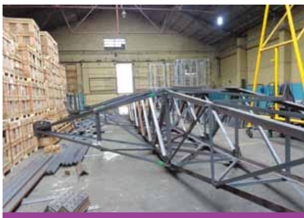
Estructura reticulada para torres de alta tensión, fabricadas por Lago Electromecánica desde 2016
