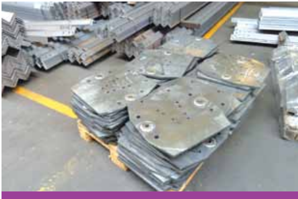
La punzonadora perfora y punzona todas las chapas nudos y también la chapa base de la torre, de un espesor de 38 milímetros.
