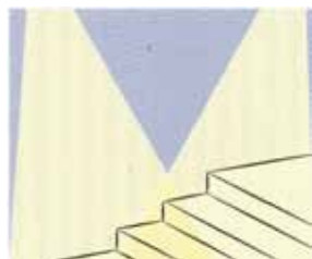
Figura 10 Eliminación de cualquier área oscura que puedan tener dos luminarias en una escalera
