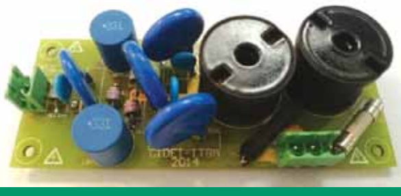
Figura 11. Circuito impreso con las dos primeras etapas
