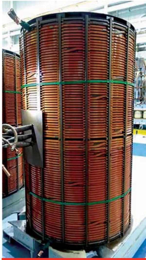
Los espaciadores termoplásticos instalados proporcionan estabilidad
