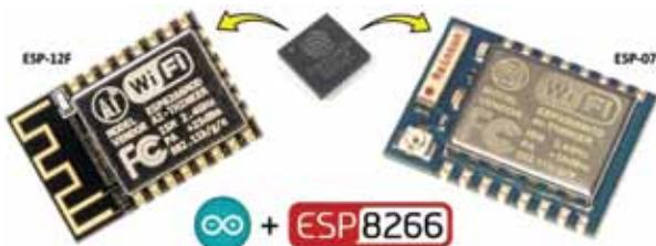
Figura 6. Microcontrolador ESP8266EX/módulos ESP12F y 07
