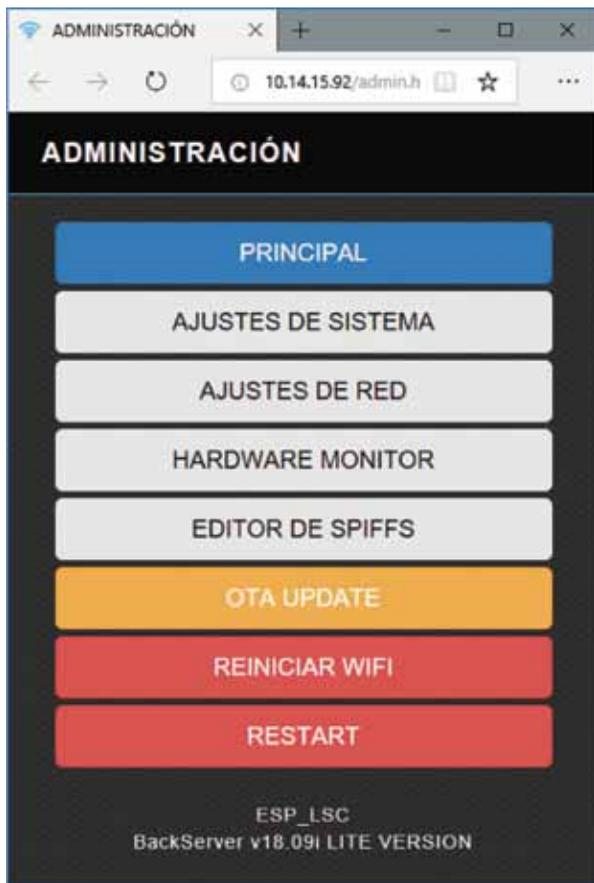
Figura 9. Servidor web integrado en el controlador
