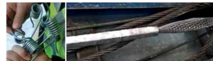
Figura 6. Se observa que, frente a la rotura del núcleo bajo tracción, el conductor se encebolla
