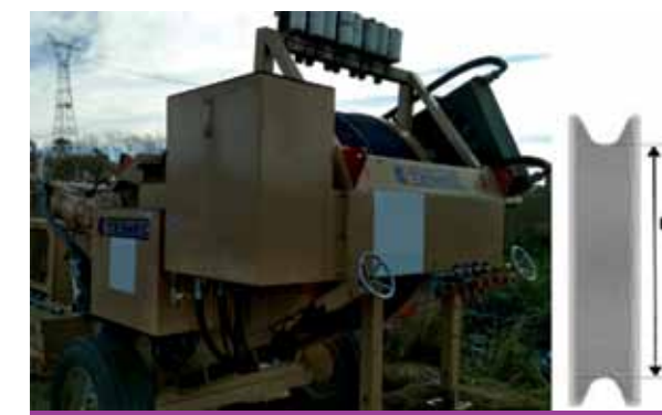
Figura 10. Frenadora apta para conductores ACSR y ACSS (izquierda) y medida a considerar en el diámetro de la roldana (derecha)
