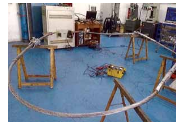
Figura 7. Ensayo de calentamiento o compatibilidad térmica. Se aprecia que las temperaturas de los accesorios no superan los noventa grados (90 °C) cuando el conductor trabaja en alta temperatura
