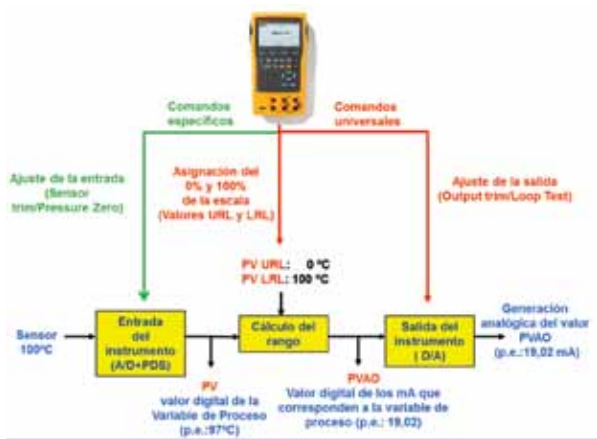
Figura 1. En rojo, las funciones y lecturas Hart realizadas con comandos universales y de prácticas comunes. En verde, la función Hart realizada con comandos específicos.
