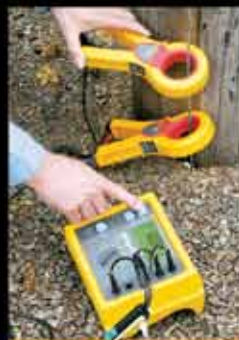
Medidores de Resistencia de Tierra
