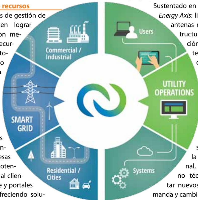
Sustentado en una red inalámbrica *Energy Axis*: libre, de 900 Mhz, sin antenas ni costos de infraestructura, con comunicación de dos vías utiliza tecnología multi-hop, de repetición y auto-registro para enviar y recibir información hacia y desde los medidores instalados. *Connexo NetSense* potencia las distribuidoras para minimizar sus costos, mejorar la eficiencia operacional, reducir las pérdidas no técnicas e implementar nuevos programas de demanda y cambio de tarifas en forma remota.
