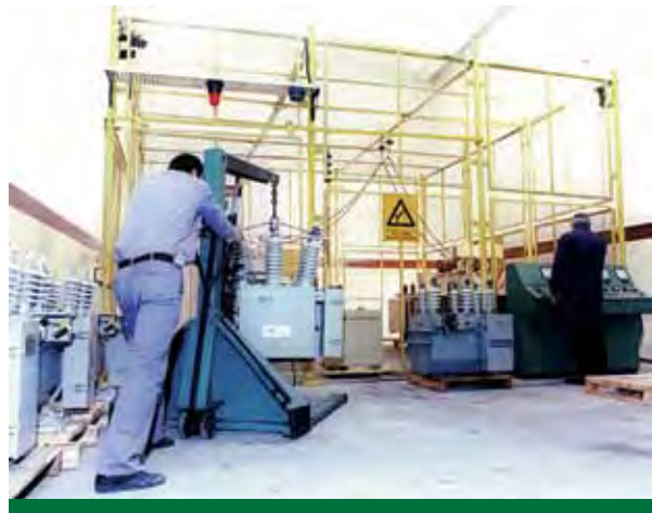
Jaula de ensayo propia para pruebas y reparaciones
