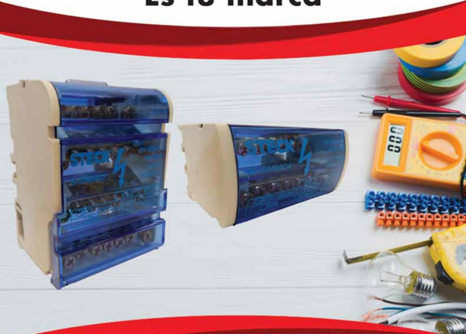
Los Bloques de Distribución son indicados para la distribución de energía eléctrica en paneles con corriente entre 100 y 125A. Su fijación puede ser en riel DIN o tornillo. El bloque desarrollado de conformidad con las normas CEI 60998 y EN 60647, tiene como material aislante el policarbonato y su tensión de aislamiento es de 500V
