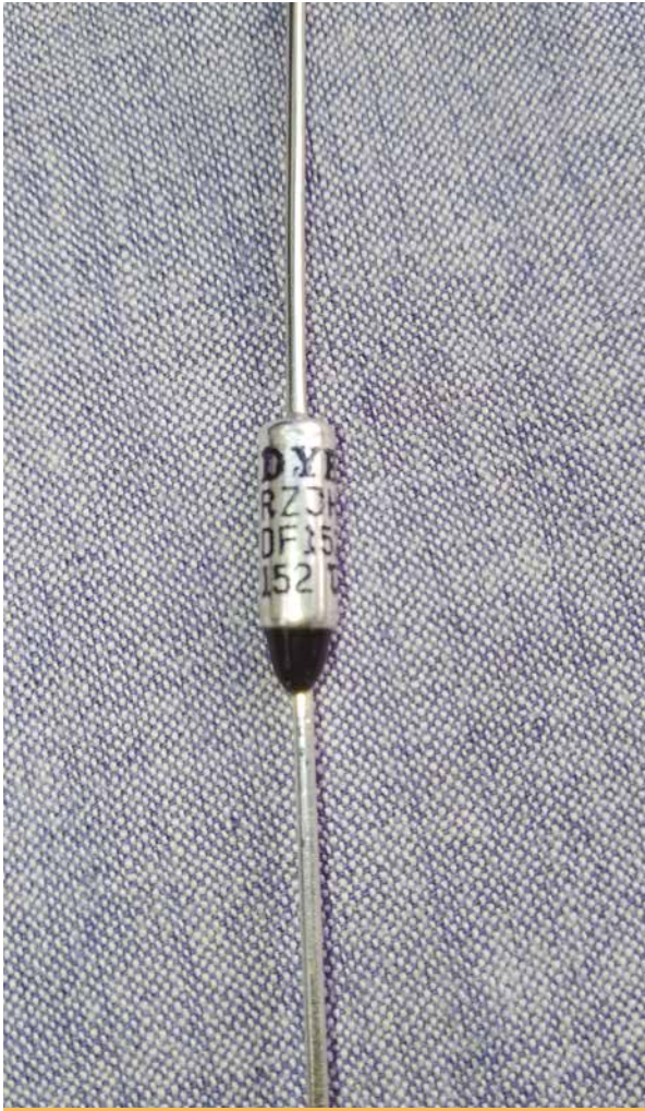
Fusible térmico de 150 °C (interrumpe el circuito cuando la temperatura ambiente dentro de la cajita supera los 150 °C)
