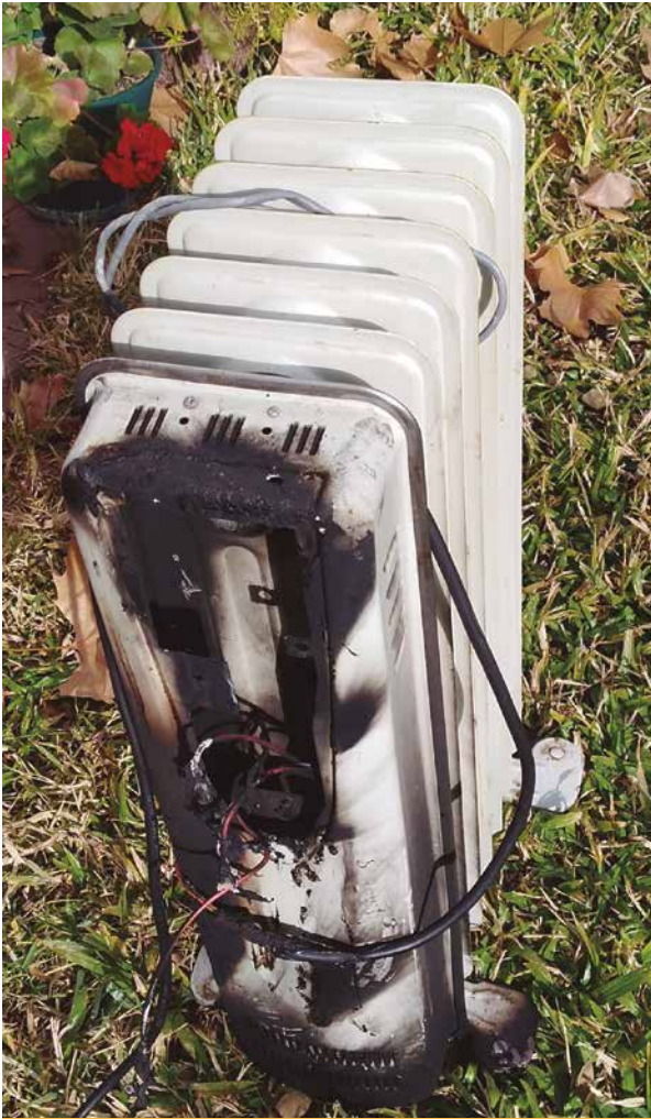
Calefactor de 2 kW quemado (principio de incendio, intoxicación)
