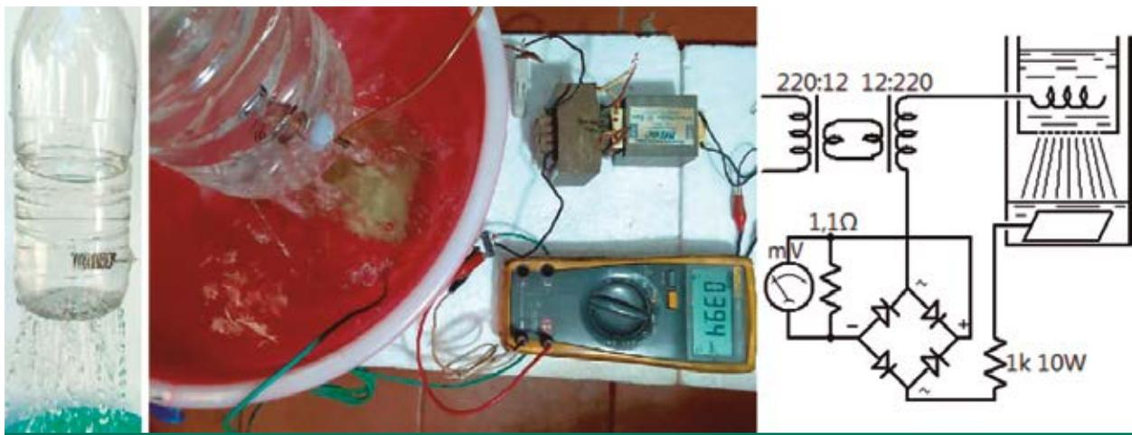
Figura 10. Aproximación a qué puede esperarse en caso de que se corte la conexión a tierra en una ducha no blindada
