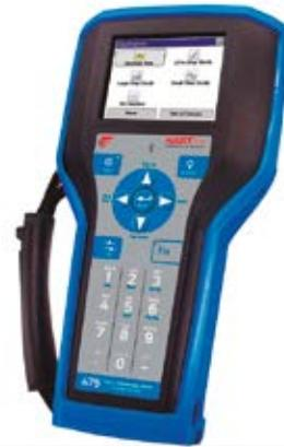
Figura 9. Un configurador de mano HART Emerson 475
