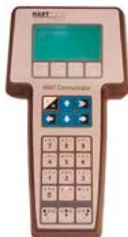
Figura 5. Un configurador de mano HART Emerson 275
