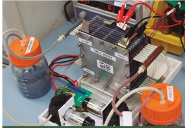
Figura 4. La batería de flujo de nanoelectrocombustible utiliza cuatro tanques, dos para electrolitos cargados y dos para electrolitos descargados, junto con bombas y membranas.
