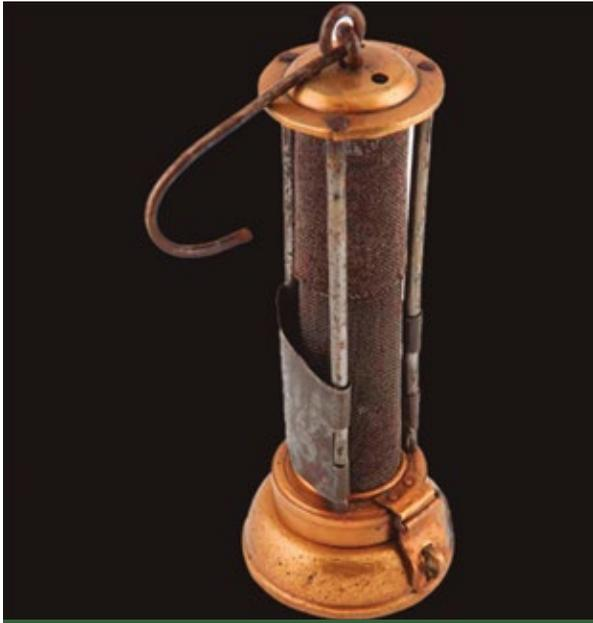
Figura 2. La lámpara de Davy, diseñada para un uso seguro en la minería subterránea.
