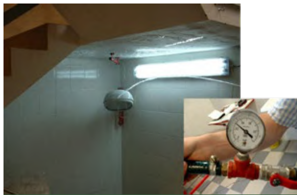
Figura 12. Cámara para verificación del ingreso de agua mediante chorro de agua según norma [30]
