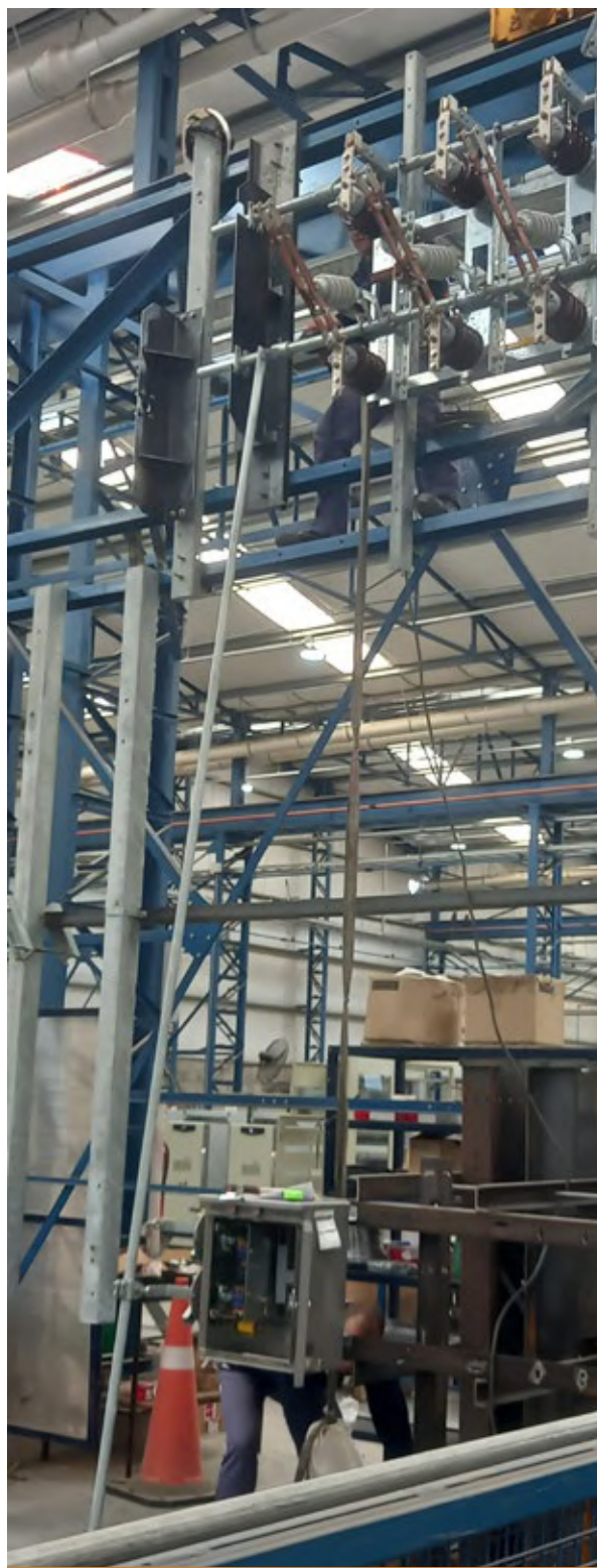
Figura 3. Ensayo de funcionamiento mecánico de las cajas de comando
