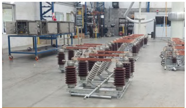
Figura 2. Seccionadores de media tensión de 13,2 kV para UTE. A la izquierda, sobre las mesas, se ven las cajas de comando.
