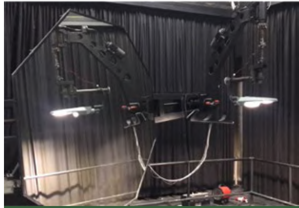
Figura 3. Fotogoniómetro LMT GO DS 2000 a espejo automático en el DLLyV FACET UNT
