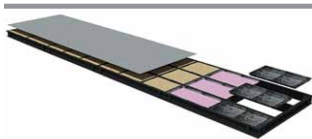
Bandejas de piso con aislación térmica
