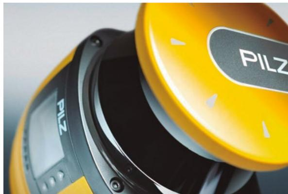
El escáner láser de seguridad PSEnscan permite la supervisión bidimensional de superficies, con un ángulo de apertura de 275 grados y un alcance del campo de protección de hasta 5,5 metros. Por sus características, es especialmente adecuado para la protección de zonas fijas o móviles y para la supervisión de accesos en entornos industriales.
