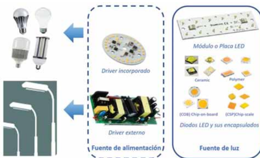
Figura 4. Principales componentes que integran la tecnología de iluminación led
