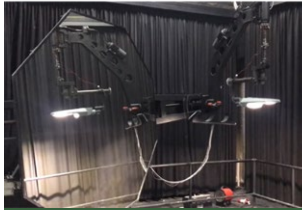
Figura 3. Fotogoniómetro LMT GO DS 2000 a espejo automático en el DLYV FACET UNT
