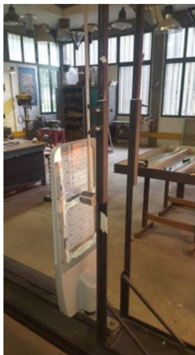
Figura 13. Martillo de péndulo para ensayo de IK en luminaria vial
