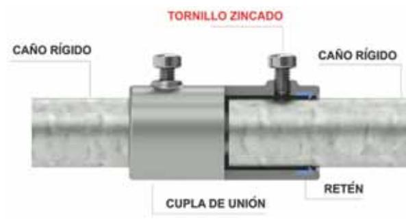
ajuste entre los accesorios y el caño lo realiza un tornillo con recubrimiento anticorrosión de diseño especial que se clava en la cañería impidiendo que se desprenda.
