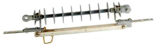
El seccionador de línea *ITD* de *ABB* es un seccionador monofásico a cuchilla de accionamiento por pértiga que se emplea para la maniobra manual de circuitos sin tensión o paralelos de líneas aéreas en sistemas de distribución con tensiones nominales desde 15 hasta 38 kV con 150 y 200 kV BIL.
