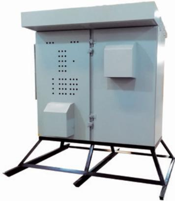
Gabinete de aparamenta eléctrica para entornos petroleros, capaz de soportar factores climáticos extremos y esfuerzos mecánicos exigentes. Se monta sobre un trineo metálico de forma piramidal que lo eleva en altura, construido con perfiles normalizados del tipo IPN, UPN y perfiles tipo ángulo.
