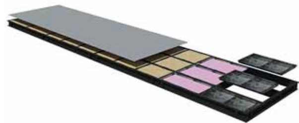
Figura 5. Bandejas de piso con aislación térmica
