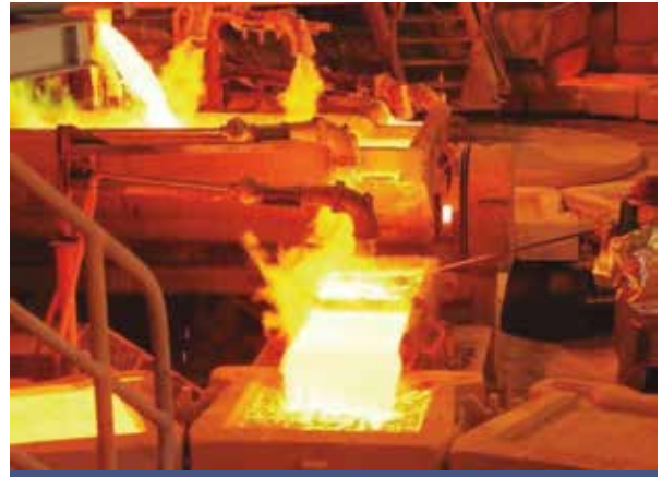
Figura 3. El cobre blíster de la fundición se vierte en los moldes de fundición del ánodo
