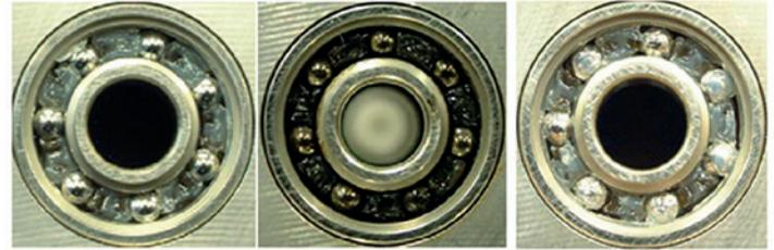
Figura 2. Cambios en la grasa de los rodamientos después de quinientas horas de operación a diferentes voltajes. De izquierda a derecha: 1.2 V ; 1.3 V ; Sin voltaje
