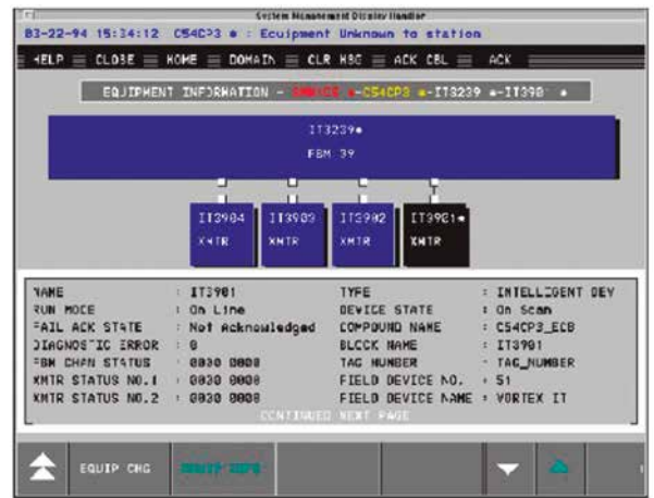
Figura 11. Software de configuración de transmisores inteligentes basado en Unix
